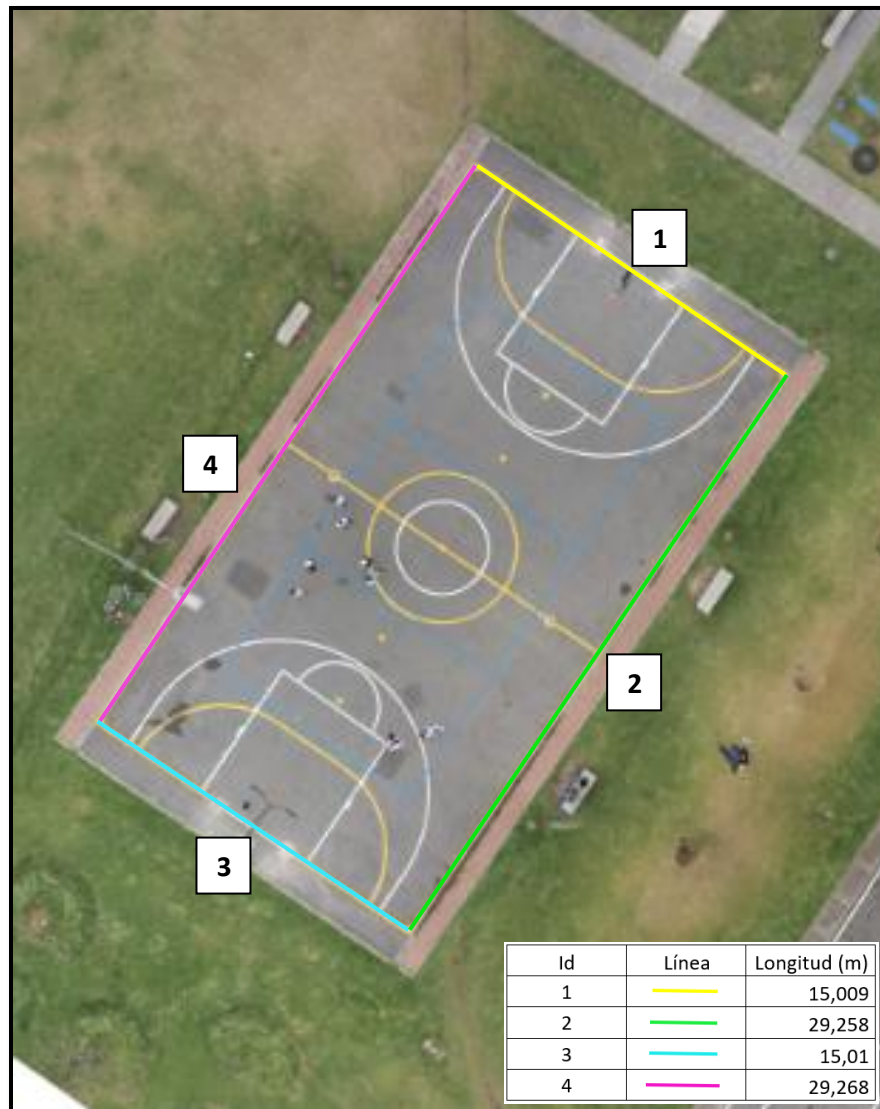
Figura 11. Identificación de longitudes medidas en el software a una altura de 20 metros
