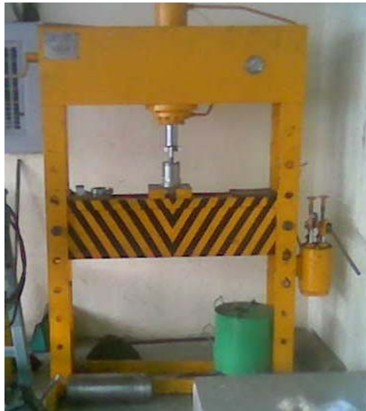
Figura 9. Prensa hidráulica con tubo extractor
