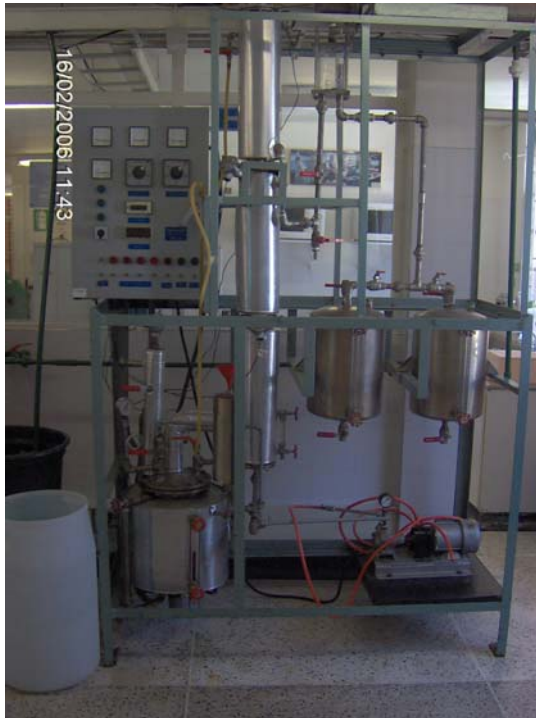
Figura 7. Torre de destilación
