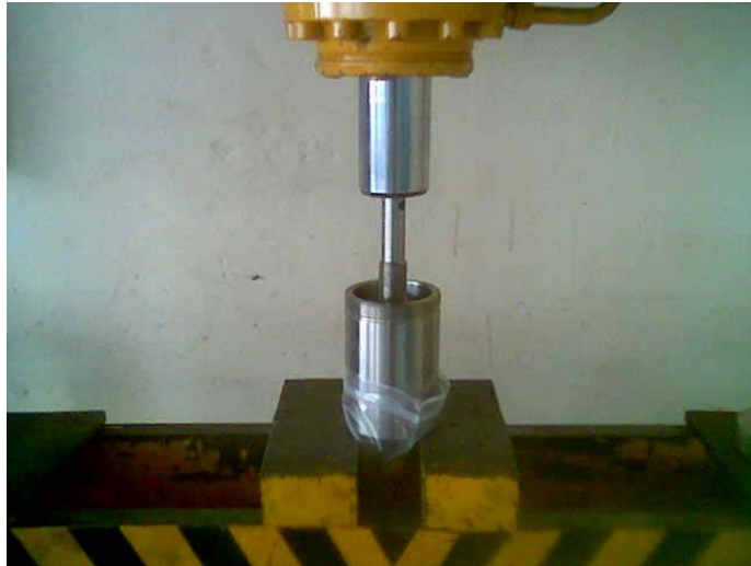
Figura 8. Tubo extractor adaptado a la prensa hidráulica
