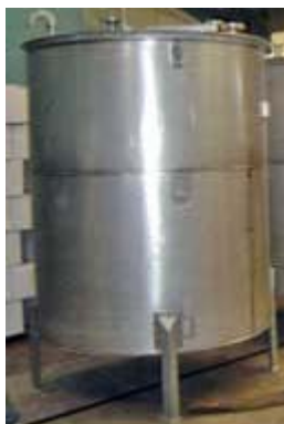
Figura 6. Tanque de extracción
