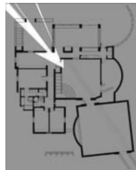
Figura 7. Planta general, rango de visión desde la puerta principal. Fuente: la autora.
