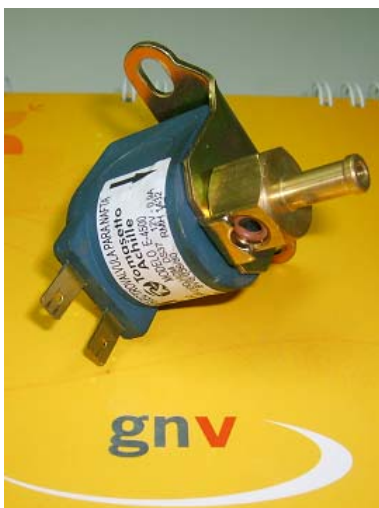
Figura 4. Electro válvulas de corte de combustible:
