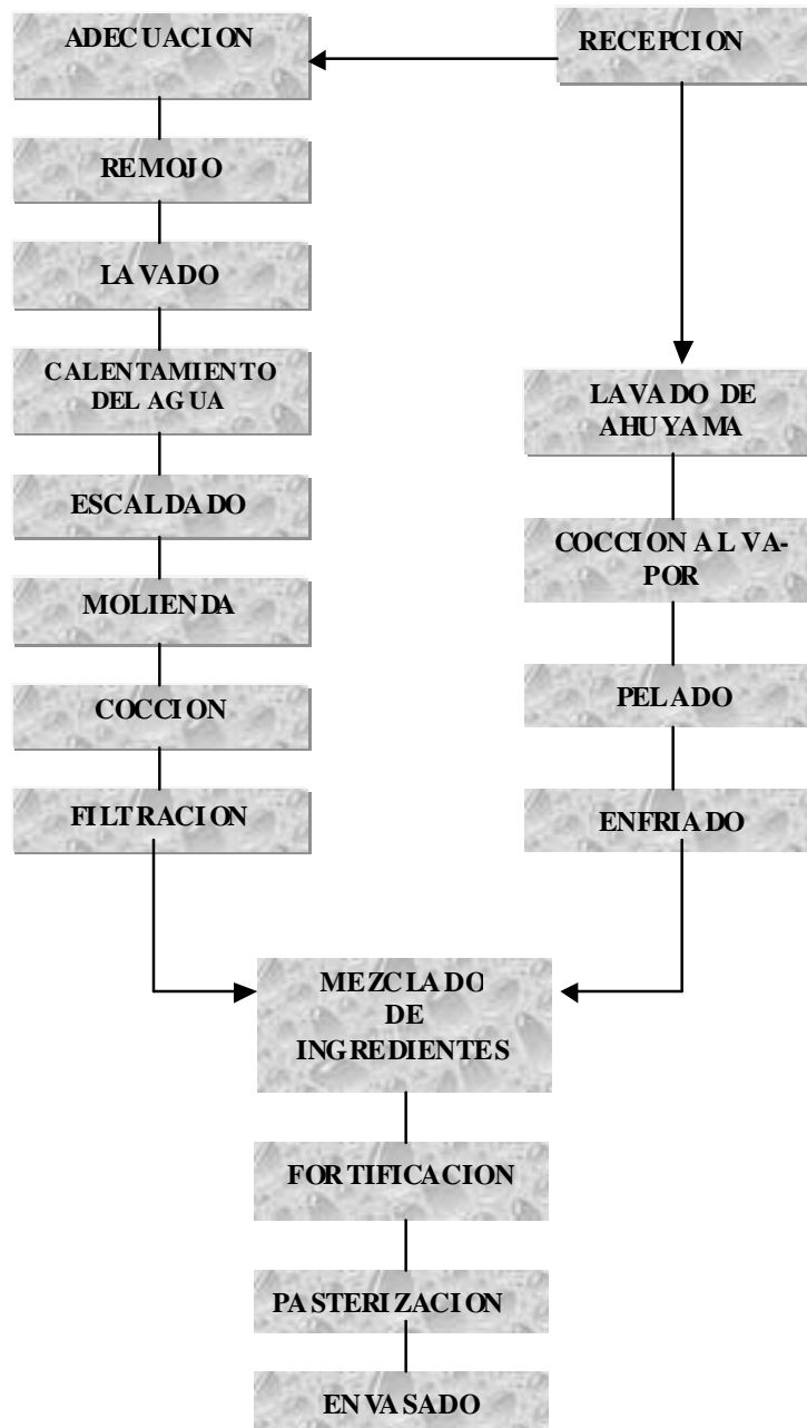
Diagrama 2. Etapas para la elaboración de la bebida a partir de leche de soya extraída y ahuyama
