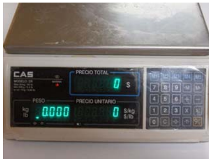
Figura 9. Báscula de precisión para pesar lechones con capacidad máxima de 30Kg.
