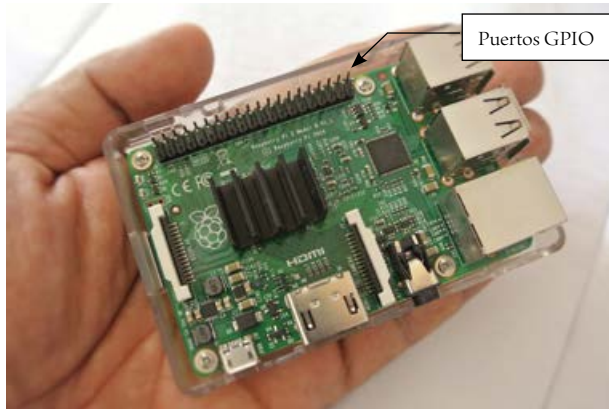
Figura 3. Diagrama general de la placa Raspberry Pi
