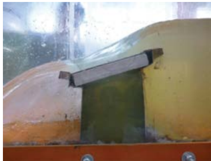
Figura 3. Vista lateral del canal de aducción. Se observa la inclinación de la rejilla
