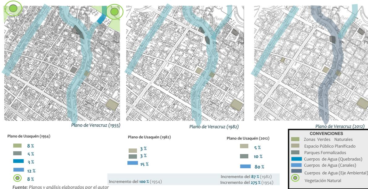
Hacia 1955 la quebrada san bruno estaba a la intemperie y se canalizaba solo hasta desembocar en el rio san francisco (canalizado en 1930). Pero en la década de 1950 se toma la decisión de canalizar la quebrada y estuvo así hasta el año 2000 donde se vuelve a ver una parte del cauce del rio san francisco por motivos de la construcción del eje ambiental.
