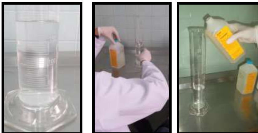
Figura 18. Proceso para la preparación de líquidos revelador y fijador, a) Pipeta con 196ml de agua, b) Adición de los líquidos respectivos en cada pipeta.
