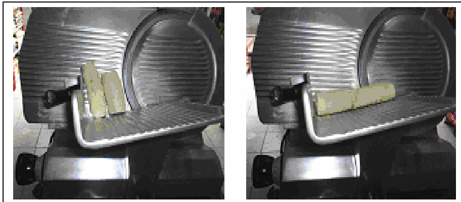
Figura 14. Tajadora de discos para corte de láminas de yuca en dirección transversal y longitudinal
