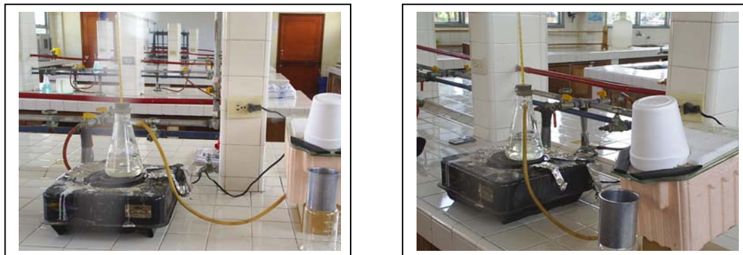
Figura 9. Prototipo del equipo Thermicon para la determinación de la conductividad térmica
