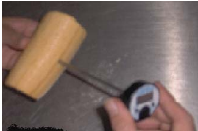
Figura 11. Toma de temperatura central en discos.
