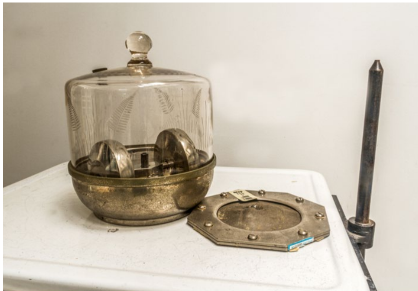
Figura 1. Molino de bronce niquelado, cubierto con campana de vidrio perforada para dosificar la mezcla de la pulpa vacunal con glicerina y solución fenicada. Museo Carlos Samper Sordo. Instituto Nacional de Salud INS.
