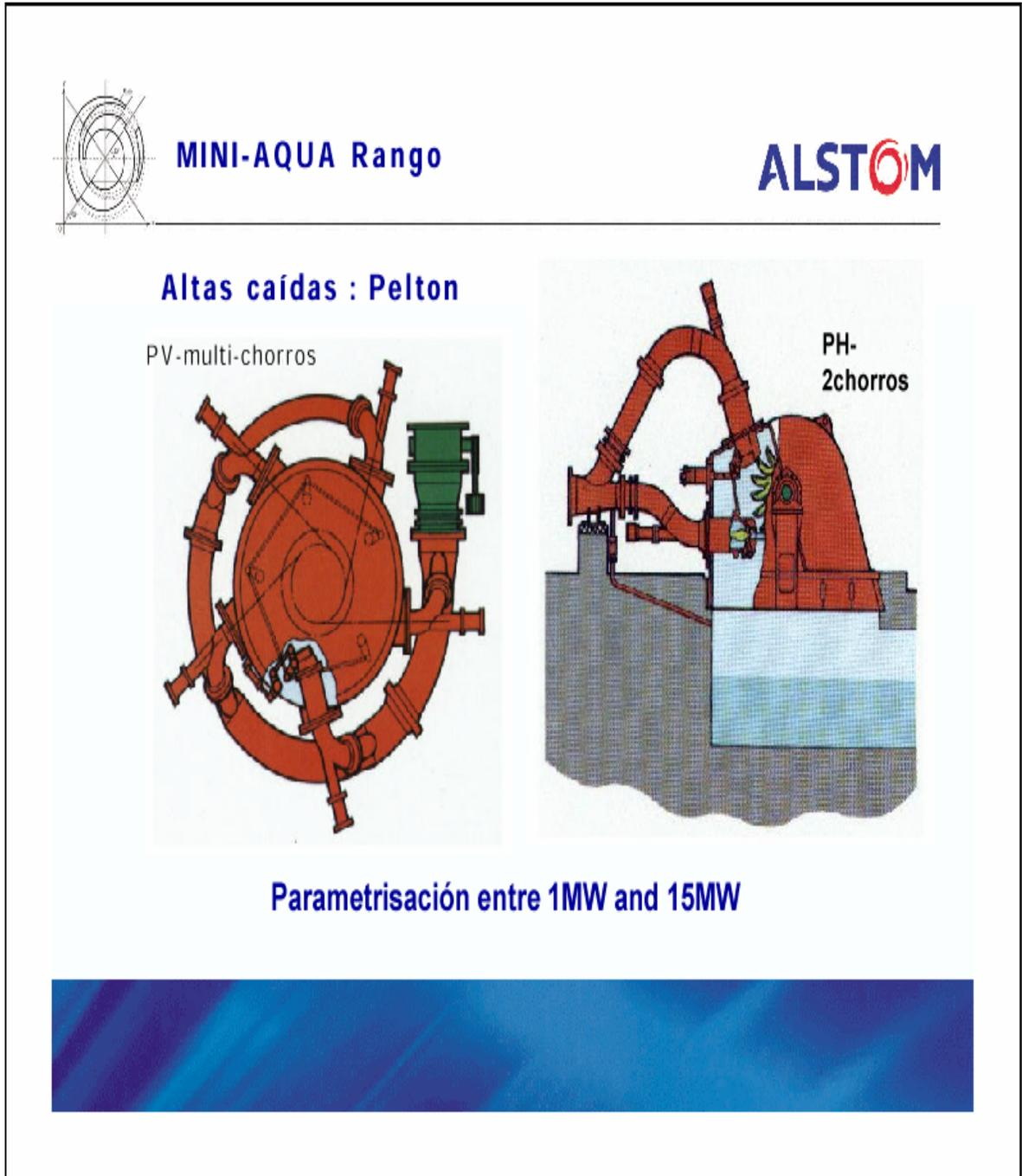
Figura B18. Configuración del grupo turbina – generador para altas caídas.
