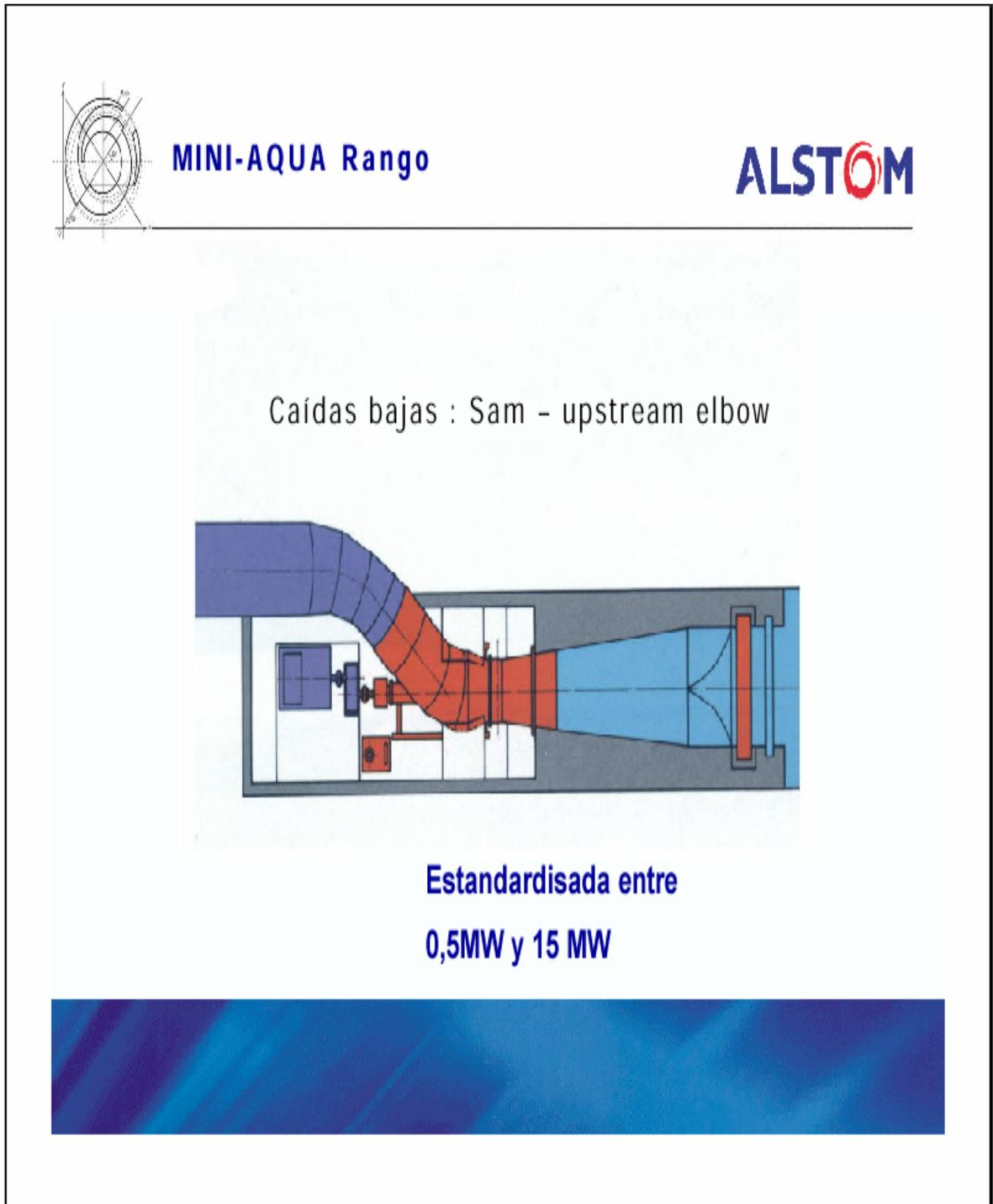
Figura 14. Configuración utilizada para caídas bajas.
