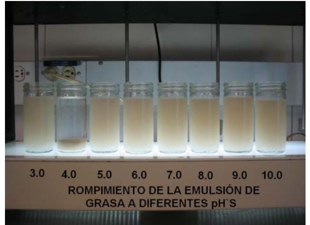
Foto 2 Dosificación de ácido pH 3.0 – 10
