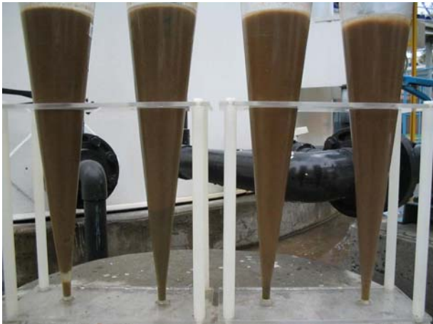
Foto 3 Lodos sedimentables en los puntos 1 - 4
