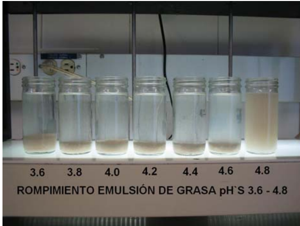
Foto 1 Dosificación de ácido pH 3.6 – 4.8
