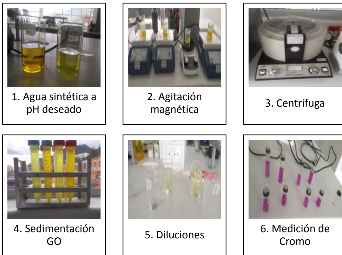
Ilustración 2. Descripción gráfica del procedimiento llevado a cabo en el laboratorio.
