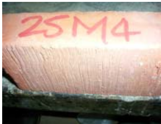
Figura 8. Textura acanalada en unidades ensayadas de 25%
