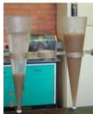
Foto 8. Conos imhoff con muestra de lodo de clarificación de agua potable.
