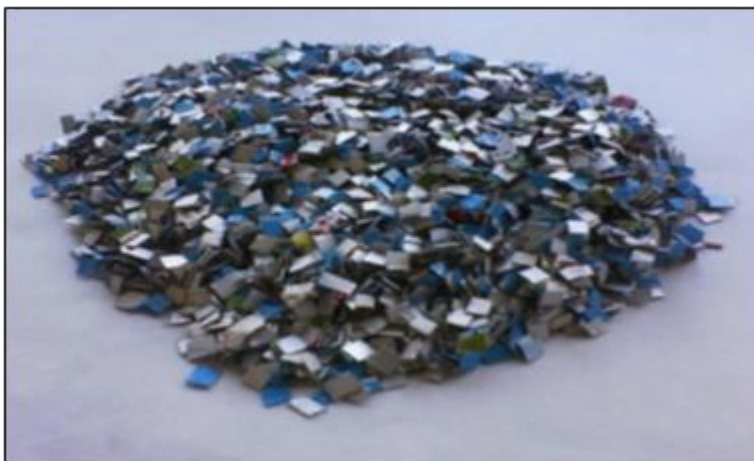
Figura 7. Muestra de Tetrapak para experimentos de pirólisis
