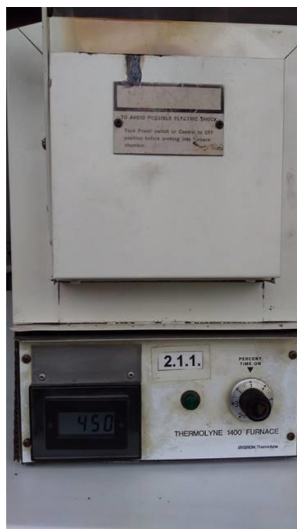
Ilustración 5. Mufla Thermolyne 1400 Furnace, con atmosfera y temperatura controlada.
