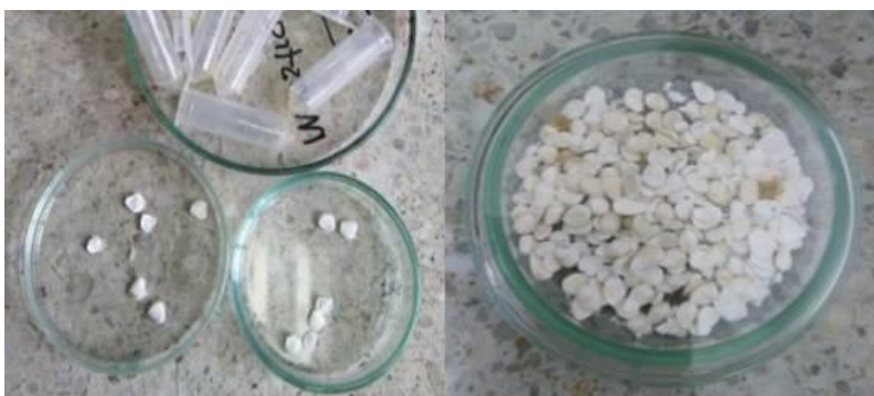
Figura 13. Obtención de polímero por método de digestión y gravimetría dextran-sacarasa/sacarosa
