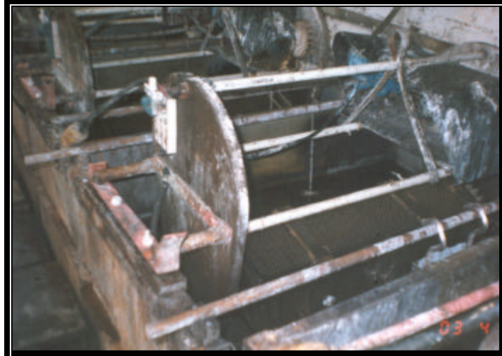
Foto 5. Proceso de zincado en Tambor
