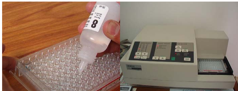
Figura 13. Aplicación de la solución stop y Espectrofotómetro para 650 nm de absorbancia.
