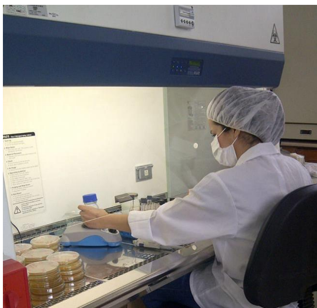
Figura 3. Siembra en placa para recuento de coliformes totales y fecales.
