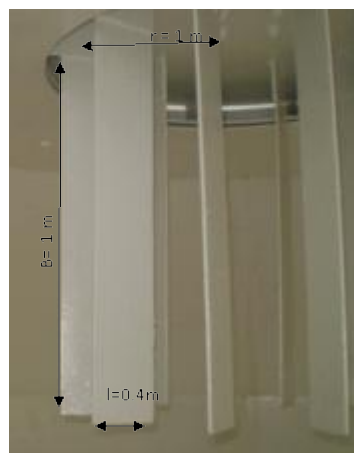
Figura 13. Elementos geométricos del agitador.
