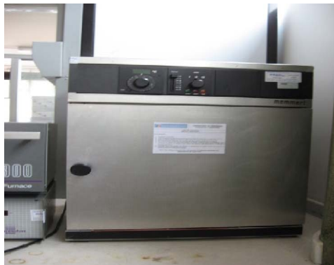
Figura 61. Horno para eliminación del contenido de humedad
