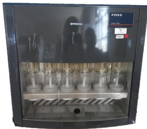
Figura 6. Equipo Soxhlet para extracción de aceite de café brocado con disolventes.
