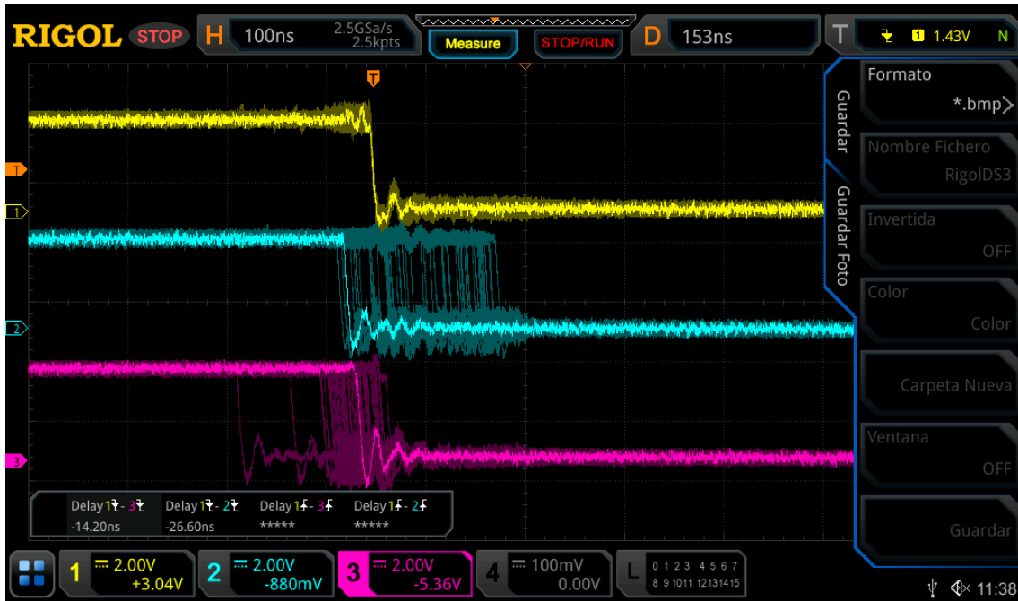
Figura 47: Barrido en el tiempo para el flanco de bajada GPS
