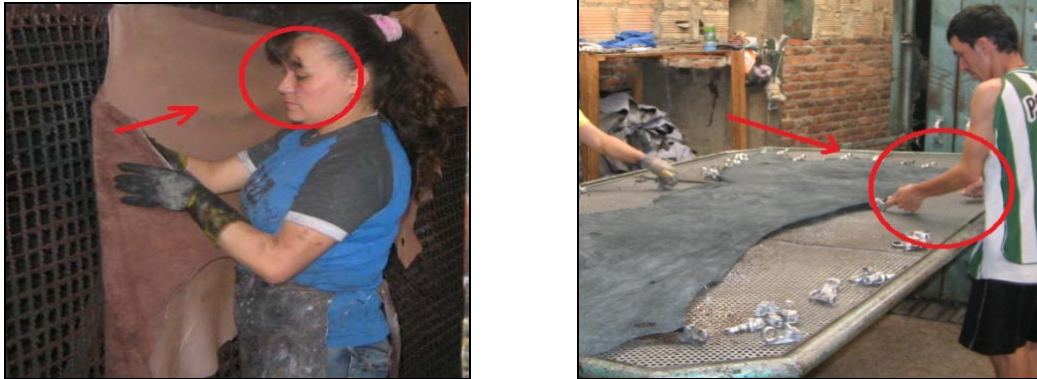
Figura 19. Operarios sin protección en el área de pintura y del togly ( secado de cueros en horno ).
