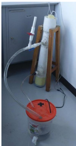
Figura 7. Reactor de fotooxidación. Fuente: Autores.
