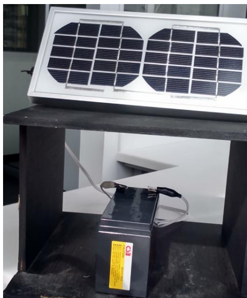
Figura 12. Panel solar y batería. Fuente: Autores
