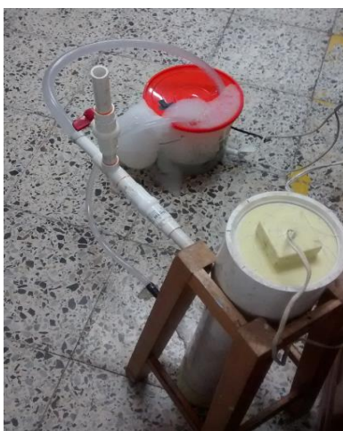
Figura 16. Corrida con Propoxur. El reactor fotooxidativo no está adecuado para compuestos que generen espuma. Fuente: Autores
