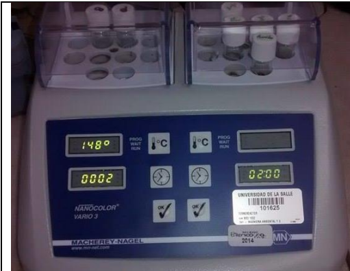
Termoreactor con las muestras.
