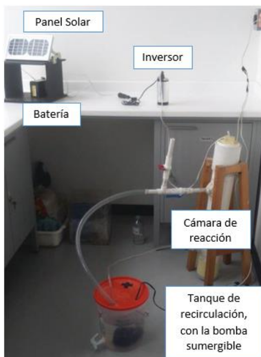
Figura 13. Reactor de fotooxidación conectado al sistema híbrido. Fuente: Autores
