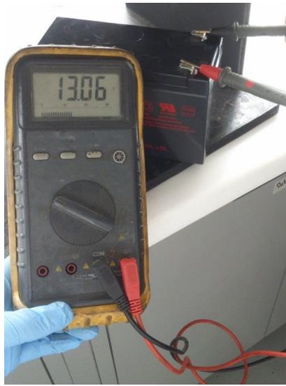
Figura 15. Voltímetro con la carga de la batería, después de 4 días de carga con radiación solar directa. Fuente: Autores.
