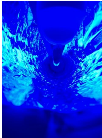
Ilustración 47 Interior del reactor ultravioleta. (Autores)
