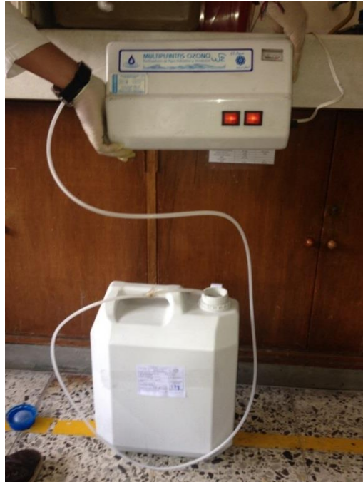
Ilustración 49 Ozonización de la muestra. (Autores)
