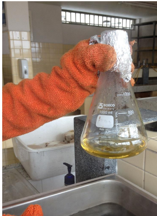
Ilustración 16 Realización del agar Cetrimide. (Autores)
