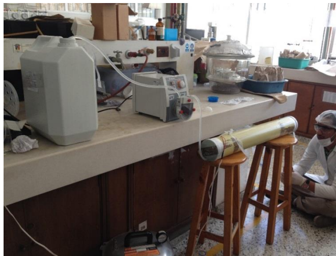
Ilustración 50 Montaje de la desinfección por el método ultravioleta. (Autores)
