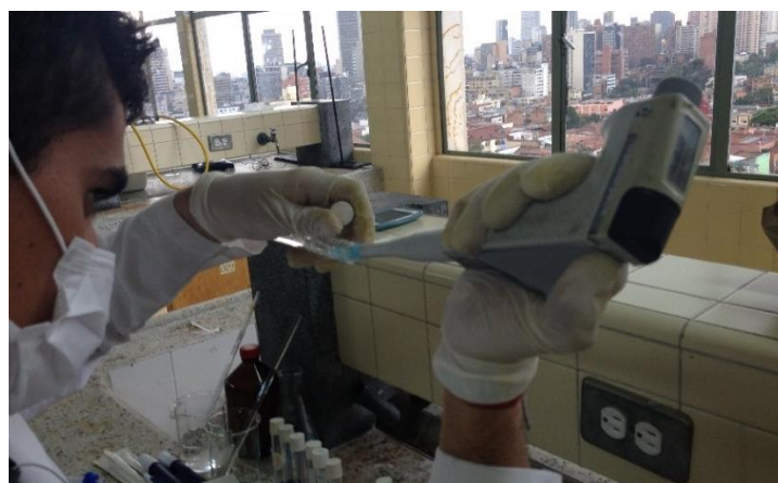
Ilustración 20 Realización de diluciones. (Autores)
