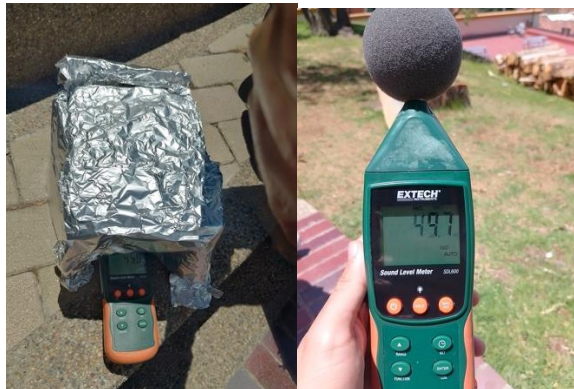
Imagen 8. Prueba Aislante Acústico.
