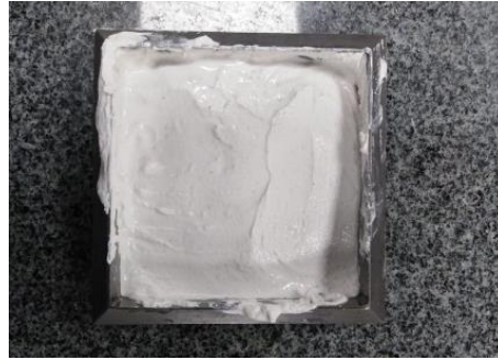
Figura 7. Mezcla de yeso para la construcción de la estructura.
