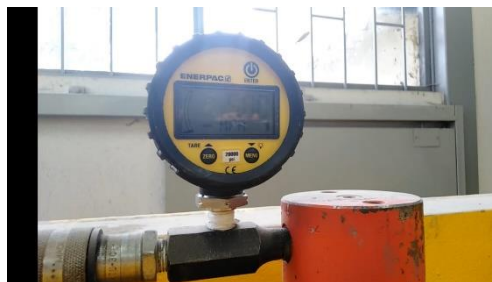
Figura 23. Instrumento para la toma de datos de carga de falla. Fuente: Autores.
