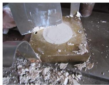
Figura 34. Preparación de la placa circular de yeso.
