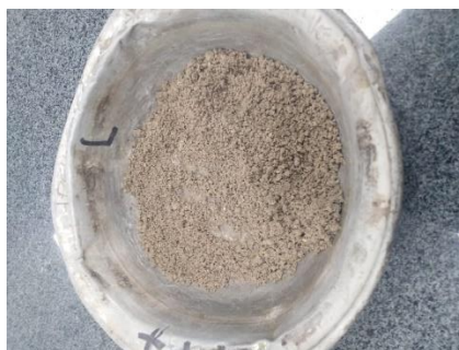
Figura 29. Mezcla de suelo simulado. Interacción suelo – suelo.
