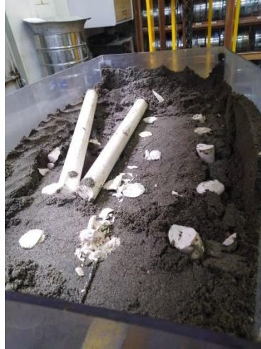
Figura 27. Evidencia de falla de los pilotes.
