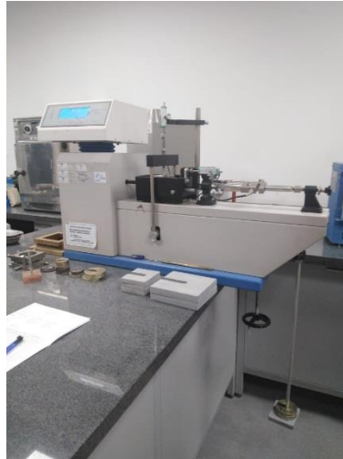
Figura 32. Carga en el brazo de la máquina. Interacción suelo – suelo.
