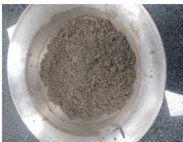
Figura 35. Mezcla de suelo simulado. Interacción suelo – yeso.
