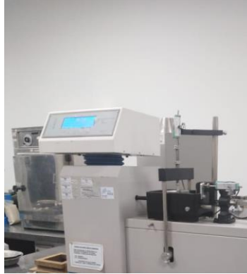
Figura 37. Ubicación de la caja de corte en la máquina. Interacción suelo – yeso.
