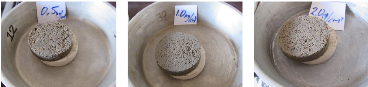
Figura 16. Resultados de ensayo corte directo. Interacción yeso – suelo.
