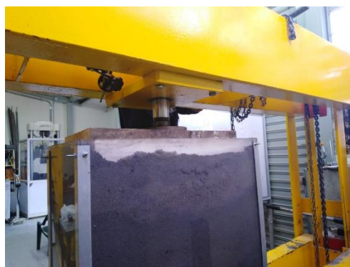
Figura 22. Ubicación de la caja de simulación para el ensayo de compresión.
