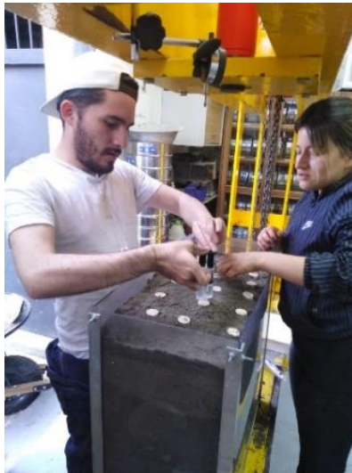
Figura 14. Unión entre los pilotes y la placa.
