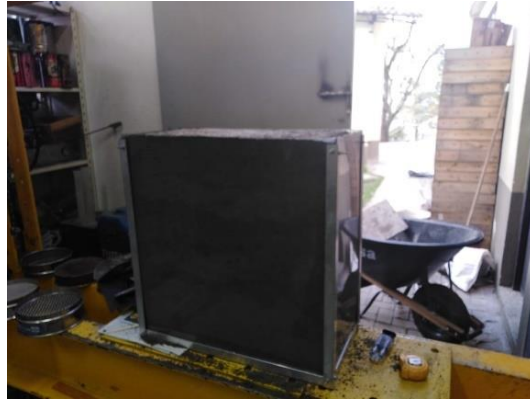
Figura 15. Interacción entre placa – pilotes en la caja de simulación.
