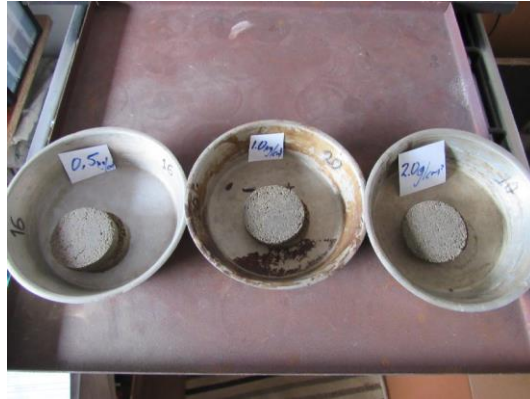
Figura 33. Resultados por cada esfuerzo normal inicial. Interacción suelo – suelo. Fuente: Autores.
