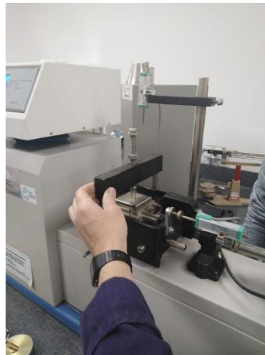
Figura 31. Ubicación de la caja de corte en la máquina. Interacción suelo – suelo. Fuente: Autores.
