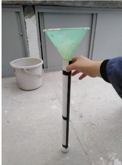
Figura 4. Formaleta de los pilotes.
