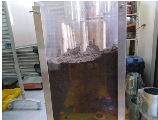
Figura 13. Compactación del suelo con verticalidad de pilotes.
