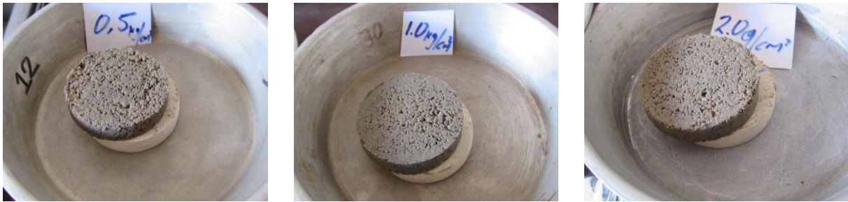
Figura 39. Resultados por cada esfuerzo normal inicial. Interacción suelo – yeso. Fuente: Autores.
