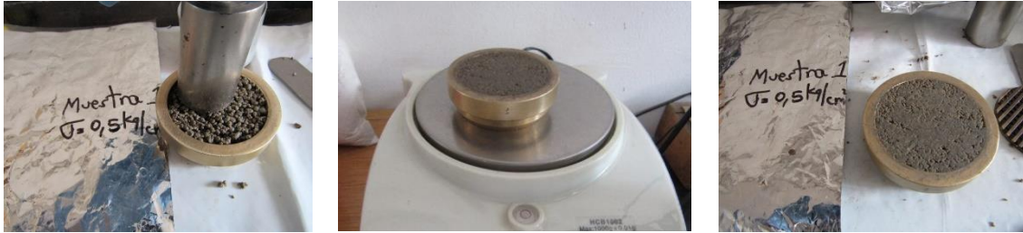
Figura 30. Colocación del material en la caja circular de corte. Interacción suelo – suelo. Fuente: Autores.
