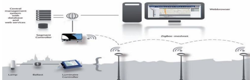
Ilustración 5. Diagrama de operación del Sistema Owlet
