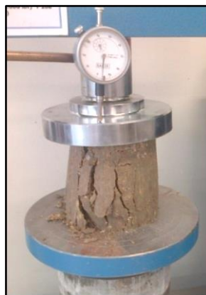
C) Falla a compresión mezcla VT 10%
