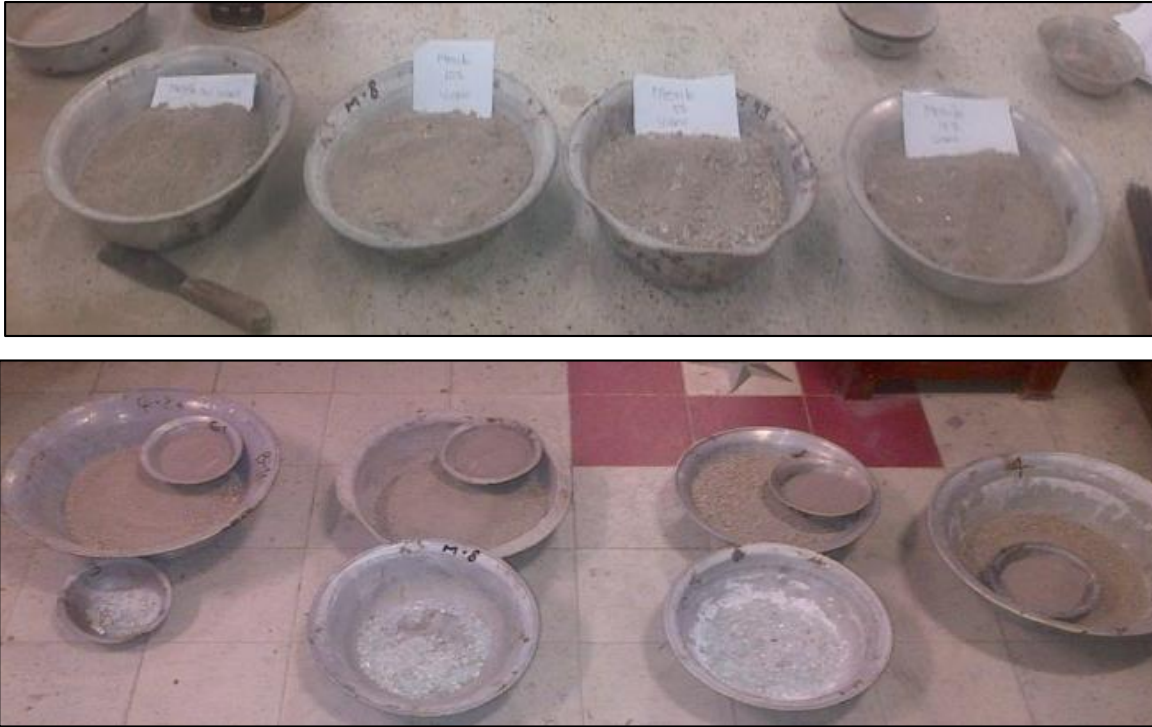
Figura 6. Preparación del material para el ensayo de Compactación
