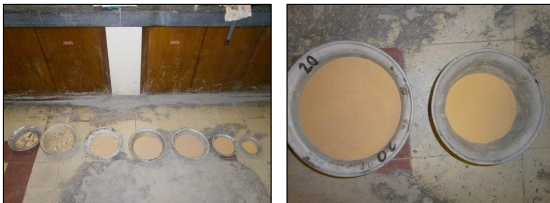
Figura 5. Muestras de material después del ensayo de granulometría
