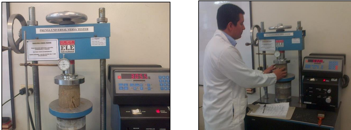
Figura 12. Ensayo de resistencia a la compresión en la Maquina Versa Tester
