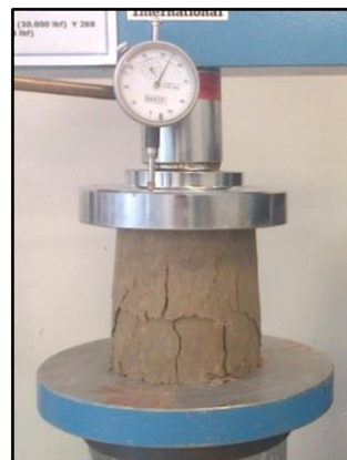
D) Falla a compresión mezcla VT 15%
