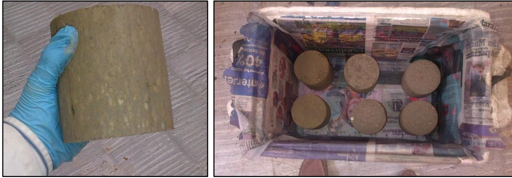
Figura 11. Extracción de la probeta y cuarto de curado de las probetas
