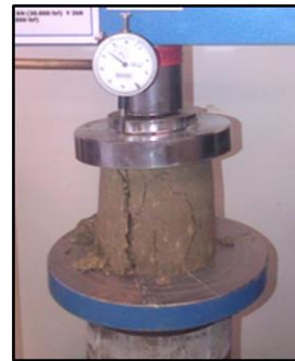
B) Falla a compresión mezcla VT 5%
