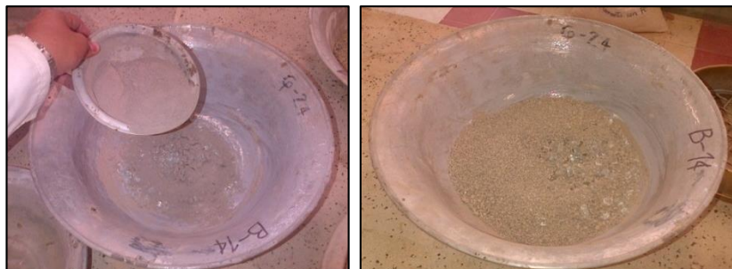
Figura 9. Mezcla del material suelo – cemento – VT 10% ensayo de compactación
