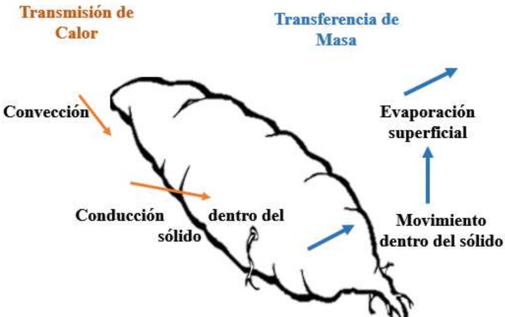
Figura 2. Procesos que intervienen en el secado de sólidos por evaporación.
