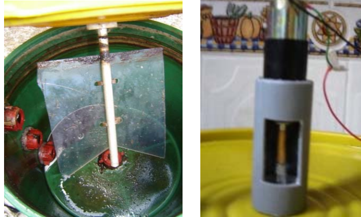
Figuras 24 y 25. Paleta agitadora y motorreductor
