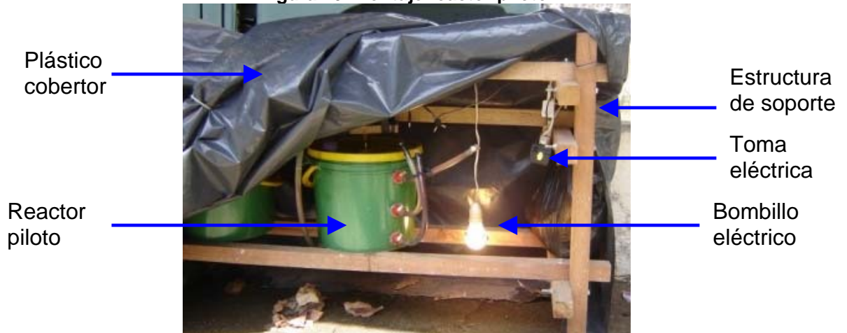
Figura 26. Montaje reactor piloto.
