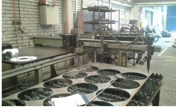
Ilustración 9: Oxicorte con pantógrafo automático
