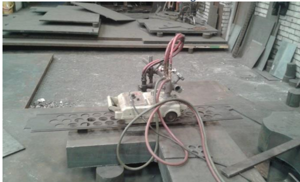
Ilustración 10: Oxicorte con tortuga semiautomático
