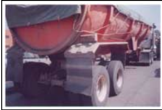
Figura 2. Contenedor de estructura sólida para transporte de escombros.
