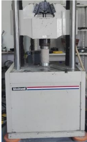
Figura 22 Montaje del ensayo de resistencia.
