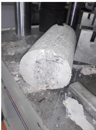
Figura 41 Ensayo de resistencia a la tracción
