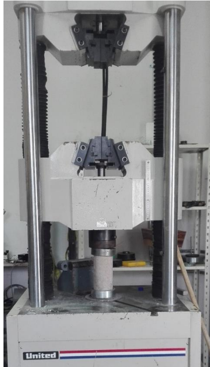
Figura 38 Ensayo de resistencia a la compresión.
