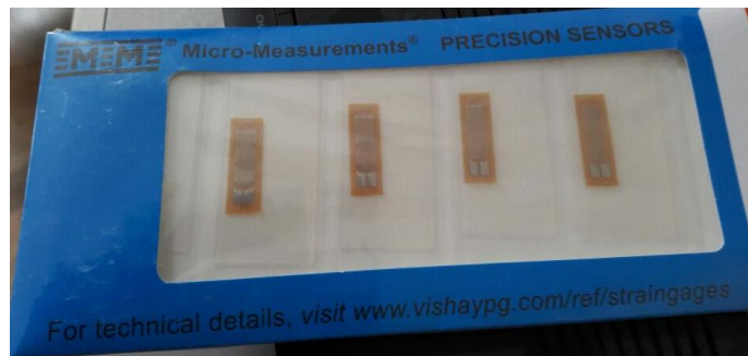
Figura 29 Galga extensométrica metálica.
