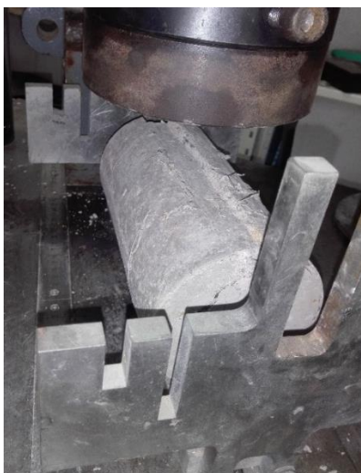
Figura 40 Ensayo de resistencia a la tracción
