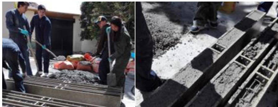
Figura 17 Llenado de los moldes de los especímenes.
