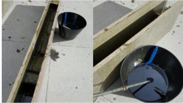
Figura 14 Engrasado de los moldes de cada uno de los especímenes.
