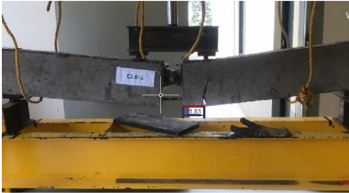
Figura 44 Configuración C1.0 / fisura a 11.81 cms.
