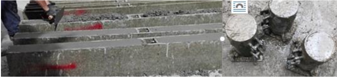
Figura 18 Enrasado de los moldes de los especímenes.
