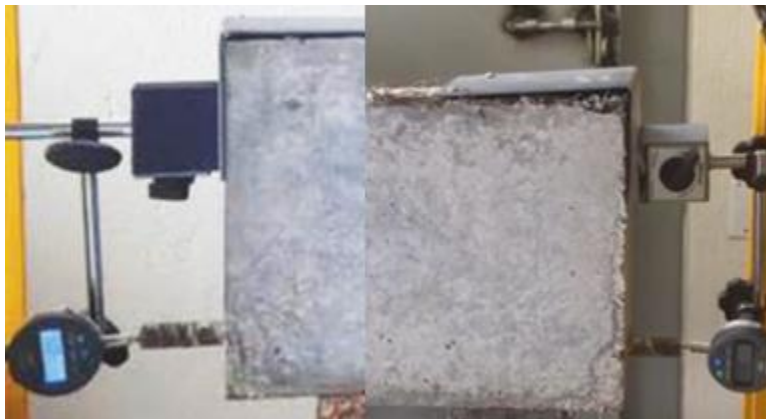
Figura 27 Deformímetros en los extremos de la viga.
