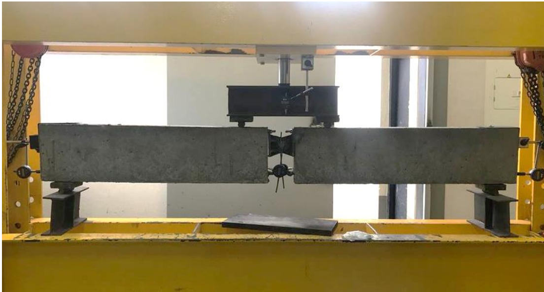
Figura 26 Marco de carga con la viga.
