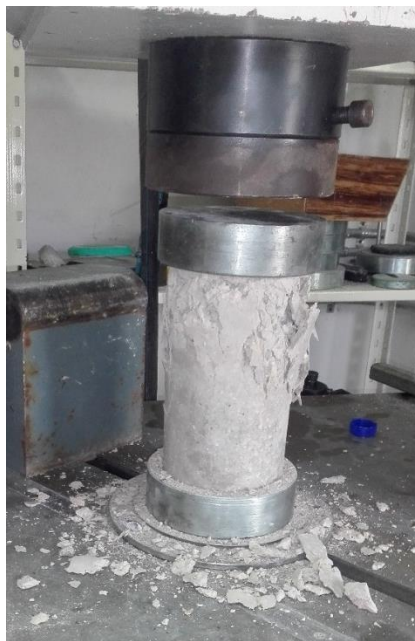
Figura 39 Ensayo de resistencia a la compresión.
