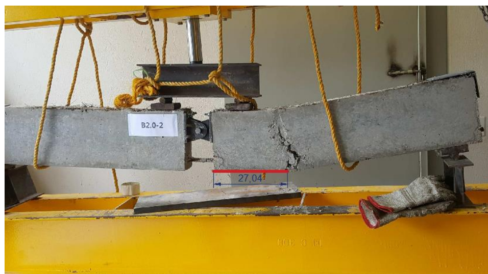
Figura 43 Configuración B2.0 / fisura a 27.04 cms.
