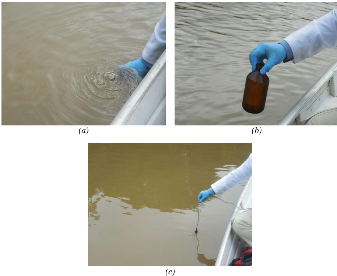
Figura 13. Obtención de las muestras de agua en el Río Cotuhé Llenado de la botella (a), Botella con la muestra (b), Medición de pH en campo (c). Fuente: (Autores,2016)
