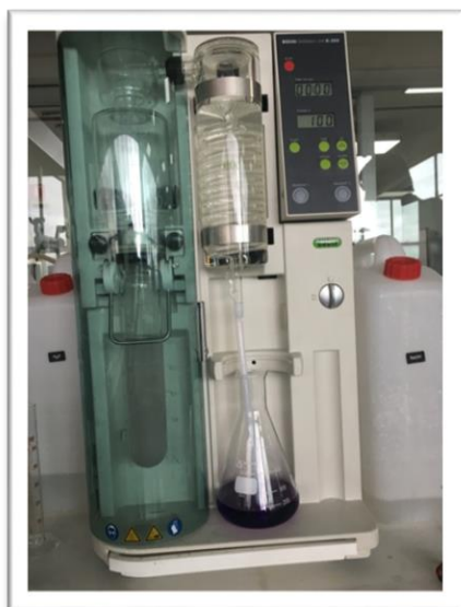
Figura 5. equipo de Kjeldahl para validar la inmovilización de la enzima
