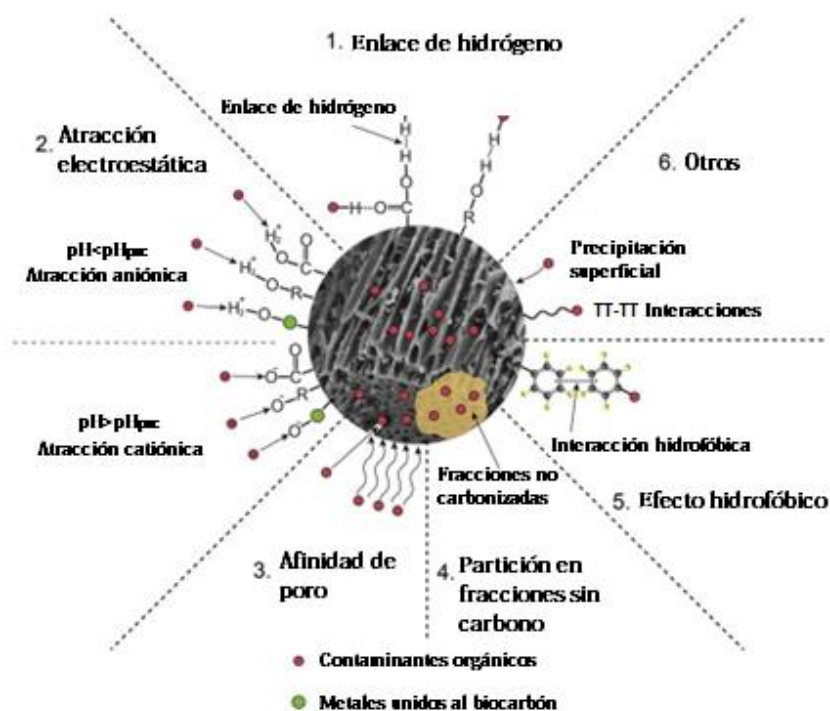
Ilustración 11 mecanismos de adsorción de contaminantes orgánicos
