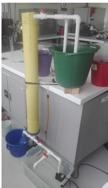
Ilustración 21. Filtración de agua impacta en los filtros piloto
