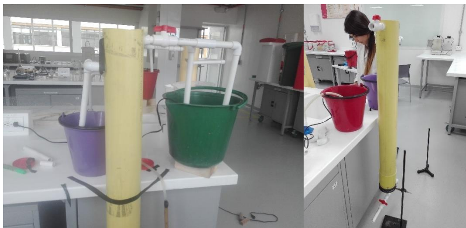
Ilustración 19. Construcción de filtros piloto
