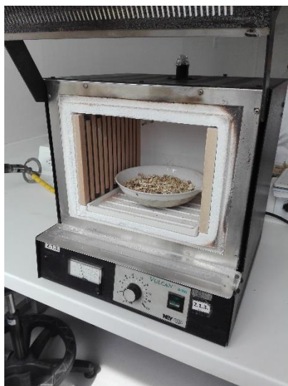
Ilustración 14. Ingreso del bagazo de caña al proceso de pirólisis en la mufla Vulcan A-550
