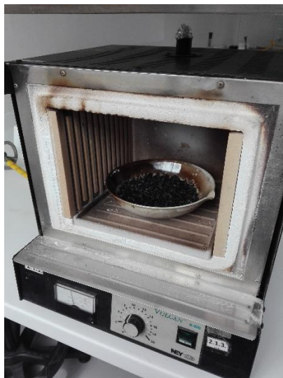
Ilustración 15. Biocarbón obtenido después del proceso de pirólisis
