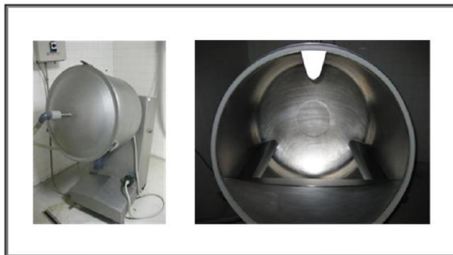
Figura 6. Tumbler o masajeador visto desde el exterior e interior
