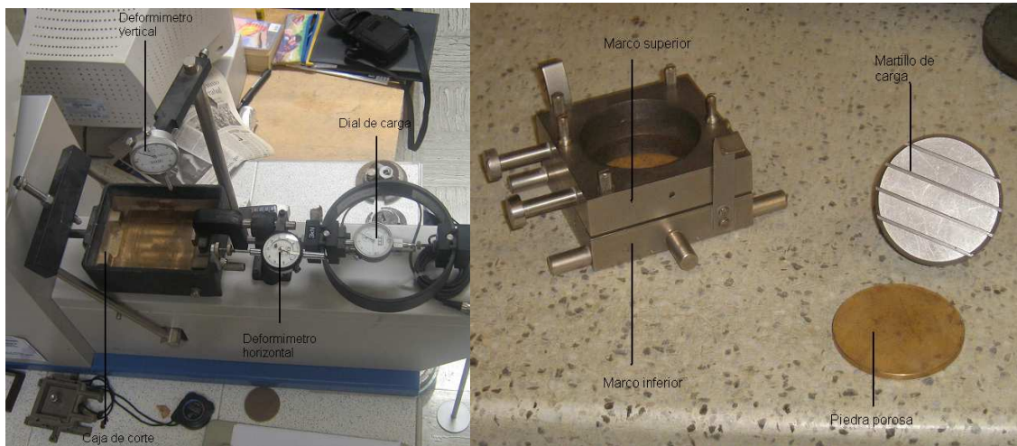
FIGURA 13. Máquina de corte directo y dispositivo de carga
