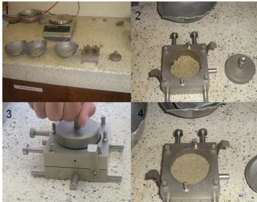
FIGURA 14. Preparación muestra para corte directo
