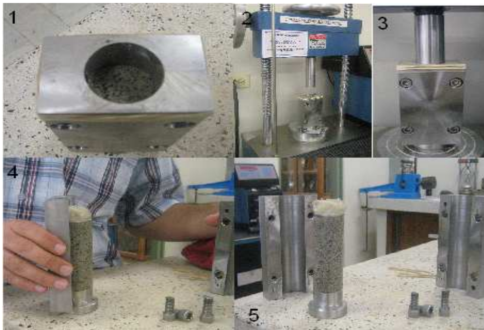
FIGURA 17. Montaje muestra para triaxial
