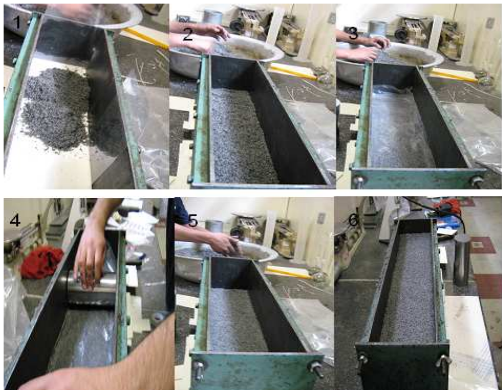
FIGURA 9. Compactación de mezcla
