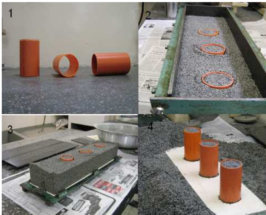
FIGURA 10. Toma de muestras para cálculo de densidad de mezclas
