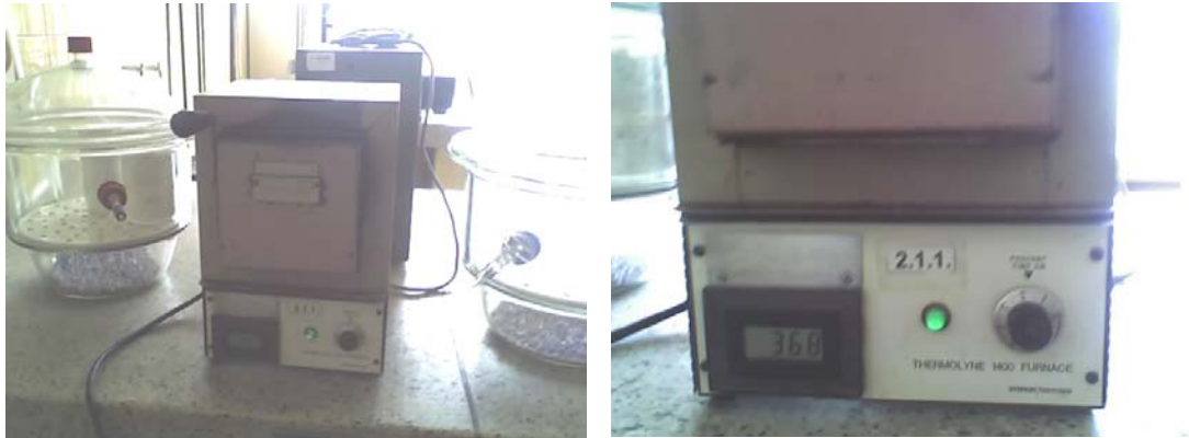
Figura 4. Proceso de ignición de la muestra a una temperatura de 600°C
