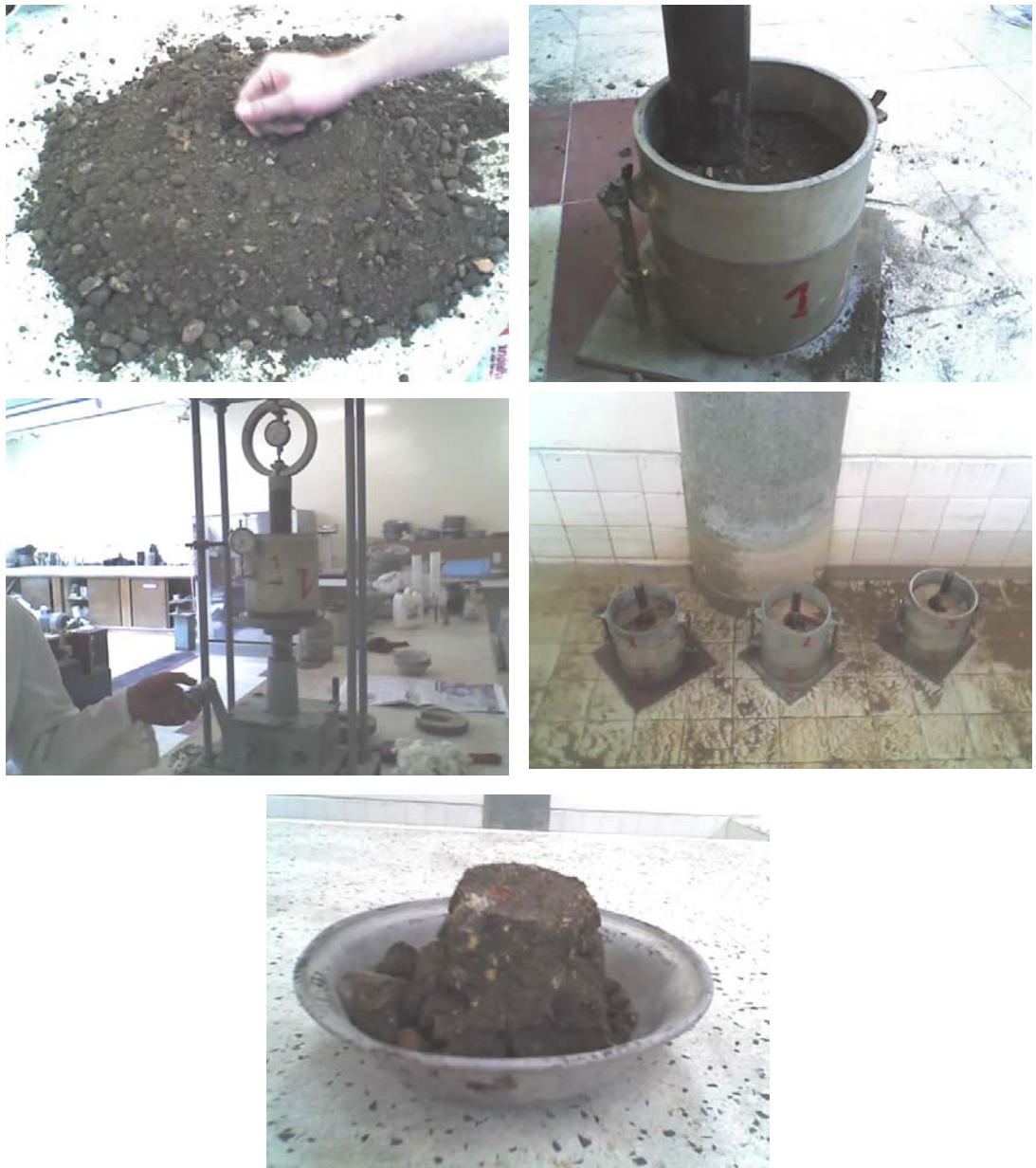
Figura 11. Ensayo de CBR (capacidad portante) material natural
