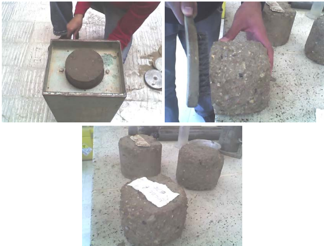
Figura 18. Extracción especímenes 6% Cemento y pasadas con el cepillo de alambre
