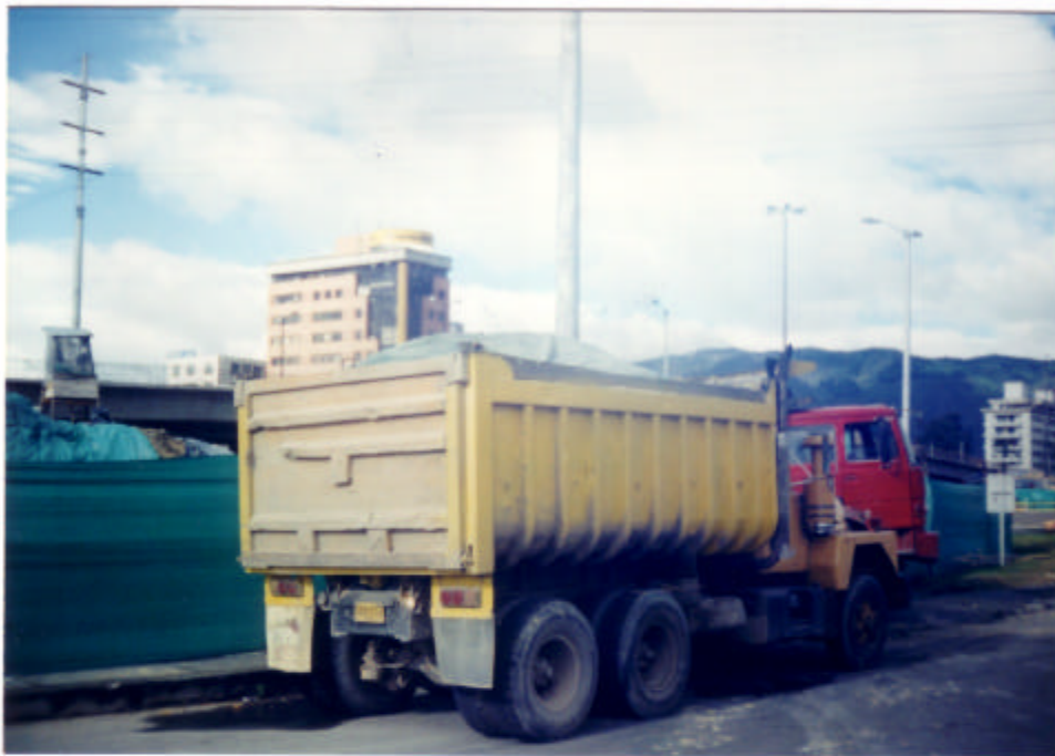
Foto 1. Volqueta debidamente cubierta.
