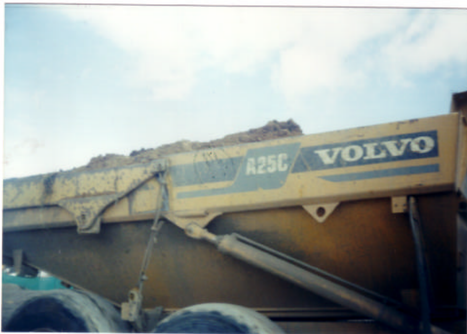
Foto 2. Volqueta sin lona de protección de material transportado.
