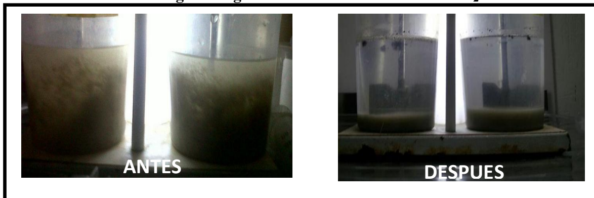
Imagen 4: Agua cruda con bentonita más CaCl 2 .
