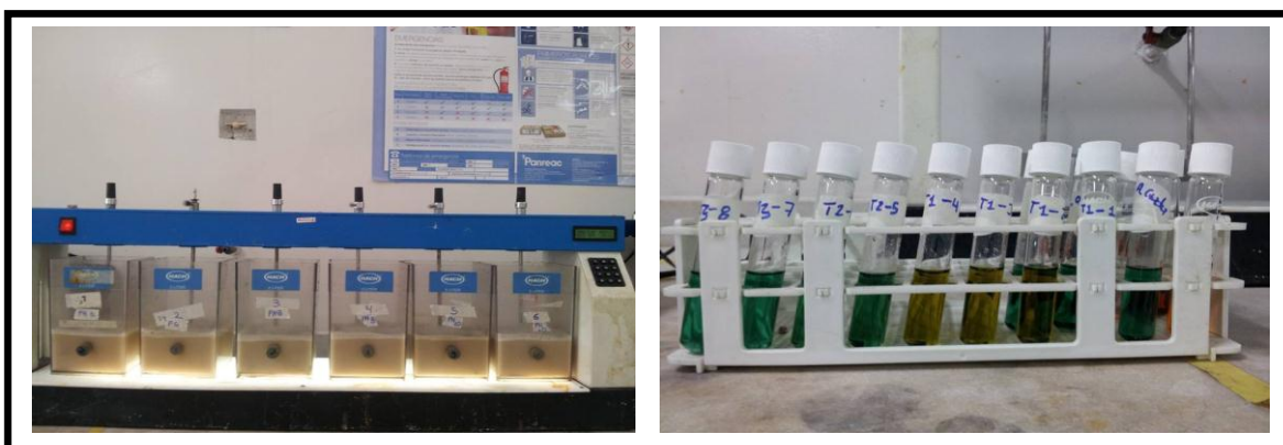
Imagen 6: Ilustración de un Test de jarras y celdas de DQO.
