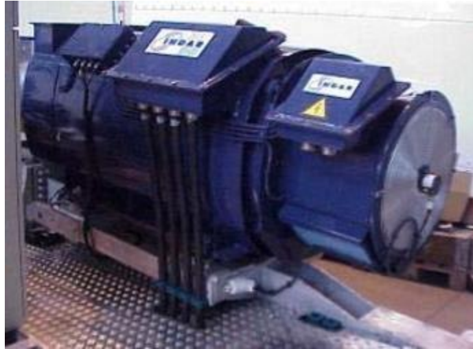
Figura 24. Vista del generador doblemente alimentado Indar NCR-450-L/4 (Echarri, 2011).
