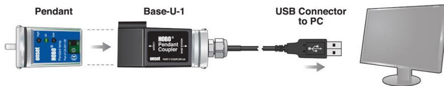
Figura 51 Esquemático de conexión HOBO Pendant Event DataLogger
