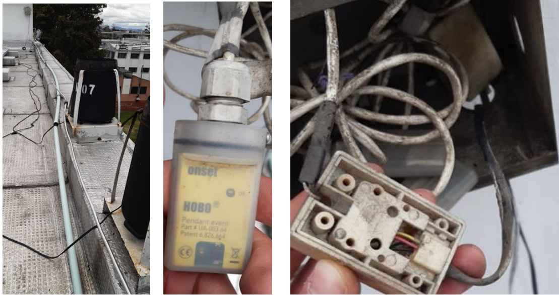
Figura 50 Conexión pluviómetros - HOBO Pendant Event DataLogger
